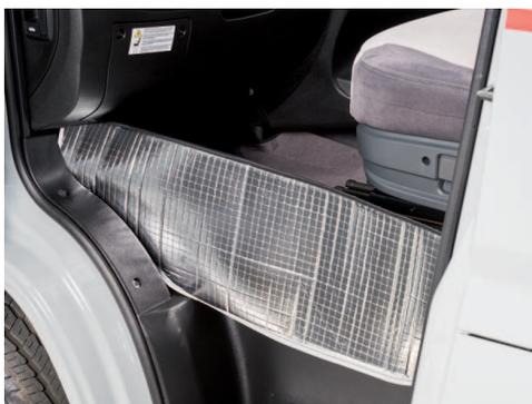
Variante mit dreidimensionaler Wannenform – schließt als Isolierung im Bereich der vorderen Einstiege dicht ab und schützt vor kalter Zugluft.
