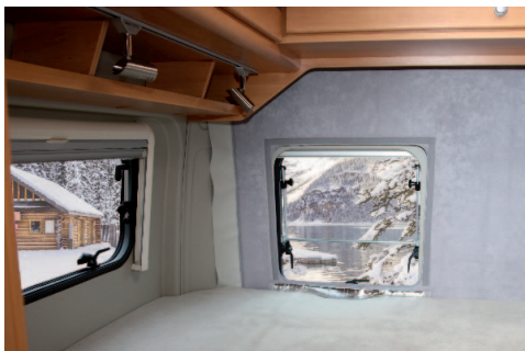
Geöffnete Fensterklappe kann einfach hinter die Matratze geklemmt werden
