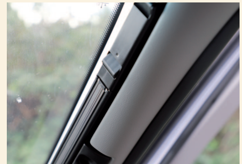
Bei Nichtgebrauch verschwindet das Frontscheibenrollo nahezu unsichtbar in einer Blende auf der A-Säule.
