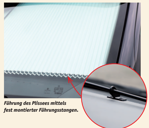
Bei Nichtgebrauch verschwindet das Frontscheibenrollo nahezu unsichtbar in einer Blende auf der A-Säule.
