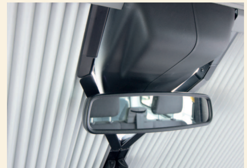
Je nach Frontscheibenrollo-Modell auch mit cleverer Mechanik zur Ausparung einer Sensoreinheit. Verschluss mittels durchgängiger Magnetleiste.
