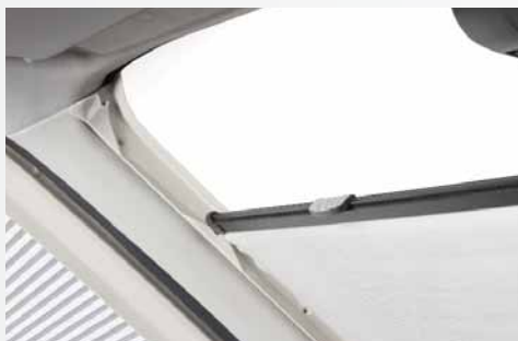
Die passgenaue Führungsschiene für das Frontrollo macht die Nachrüstung einfach. Lieferbar für Fahrzeuge mit und ohne Rückspiegel.
