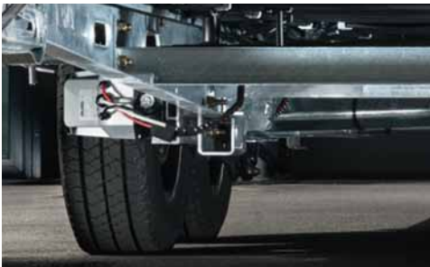
Mehr Bodenfreiheit mit AL-KO CHASSIS mit der „M“-Prägung (Einachser ab Mj. 2010, Tandem ab Mj. 2015).
